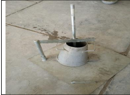
تجهیزات اسلامپ بتن
