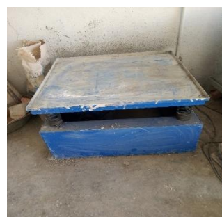
میز ویبره سنگدانه ها
