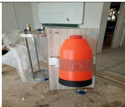
دستگاه نفوذ پذیری خاک با بار ثابت
