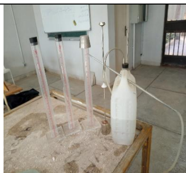
تجهیزات تعیین ارزش ماسه ای SE
